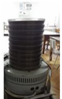
Instalație de cernere a pulberilor
