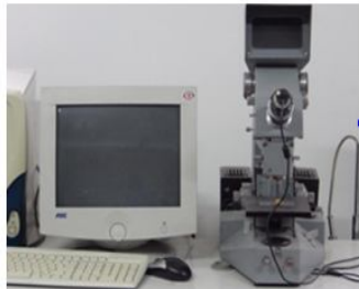
Microscop MC5A cu cameră video pentru achiziție și stocare de imagini pe calculator
