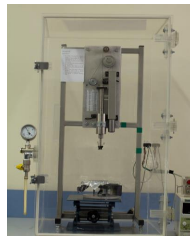
Instalație de depunere prin imersie a filmelor subțiri (Dip-Coater)
