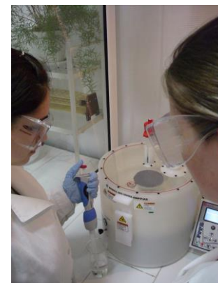
Instalație depunere centrifugală filme subțiri (Spin Coater)
