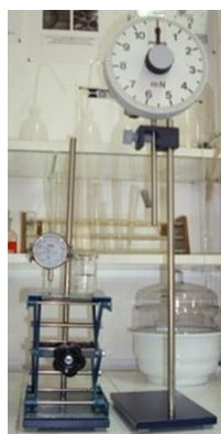
Instalație pentru determinarea unghiului de contact și a umectabi- lității substraturilor
