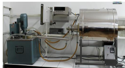
Instalație pentru măsurarea rezistivității în funcție de temperatura (home made) –senzor vapori de alcool
