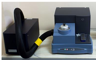
Aparat pentru analiză calorimetrică diferențială DSC Q20, TA Instruments
