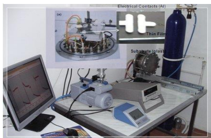
Instalație măsurare proprietăți electrice filme subțiri (home made)
